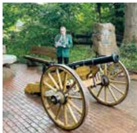
das Kommando. Bei dem Geschütz handelt es sich um eine Salutkanone vom Typ „Gebirgsgeschütz“ Kaliber 70 mm. Die Hinterlader-Kanone mit einer Länge von 1500 mm und einem Gewicht von 160 kg verfügt über einen Querblocverschluss mit Hülsenauswerfer. Montiert ist sie auf einer durch Wilfried Gausmann und Fabian Wesselkock gefertigten Lafette mit Holzrädern.
